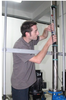
在垂直管道上 安装传感器
